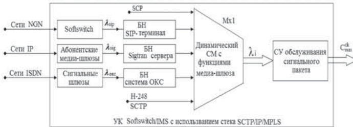
Рис. 1. Структурная схема функционирования модели, для описания процесса обслуживания служебного трафика
