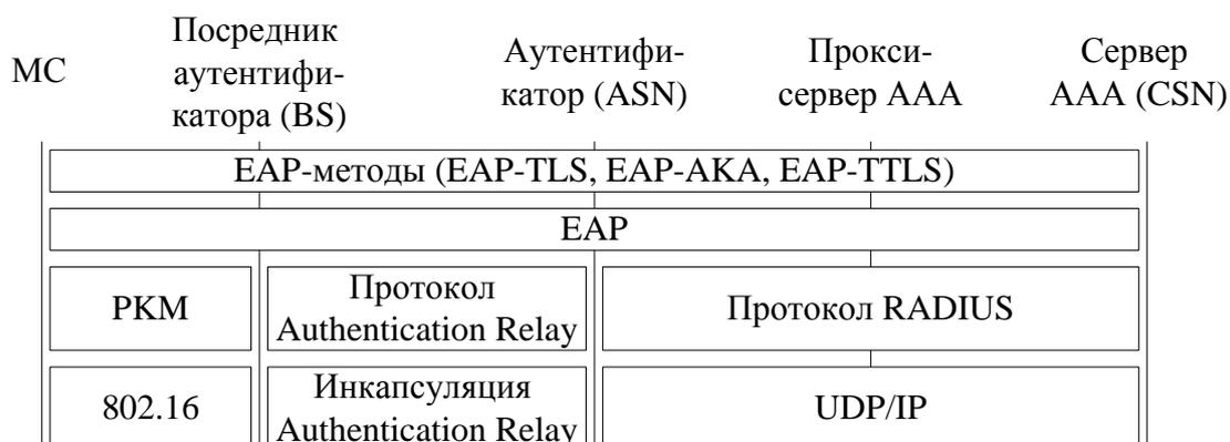
**Рис. 3.18. Стек протоколов, используемых при аутентификации**
